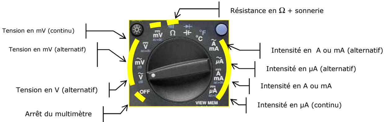
Fig 2 : Mesure d'une **tension** ou d'une **résistance**
